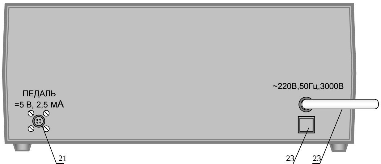
Рис.2 Задня панель електронного блоку
